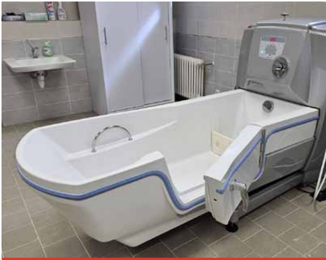
Hlavním specialitou nové vany je boční vstup pomocí dvířek.
