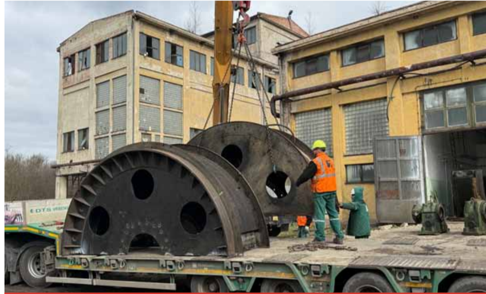
Těžní stroj, který se přestěhoval do Podkrušnohorského technického muzea, sloužil k transportu horníků a vytěženého materiálu.
