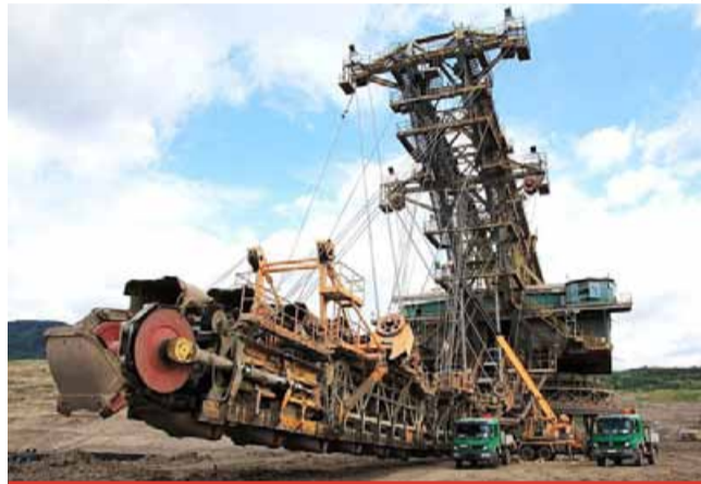
Korečkové rypadlo RK 5000 sloužilo k dobývání skryvkové horniny v uhelném lomu ČSA a stavět ho museli technici před 40 lety přímo tam. Je to vlastně největší stroj u nás v ČR, možná i ve střední Evropě. Je to 5,5 tisíce tun vážící stroj, který má na délku 140 a na výšku 40 metrů.
